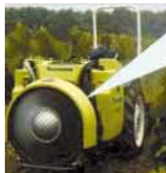
L'atomizzatore deve essere opportunamente regolato per distribuire la soluzione in una parte limitata della chioma.
